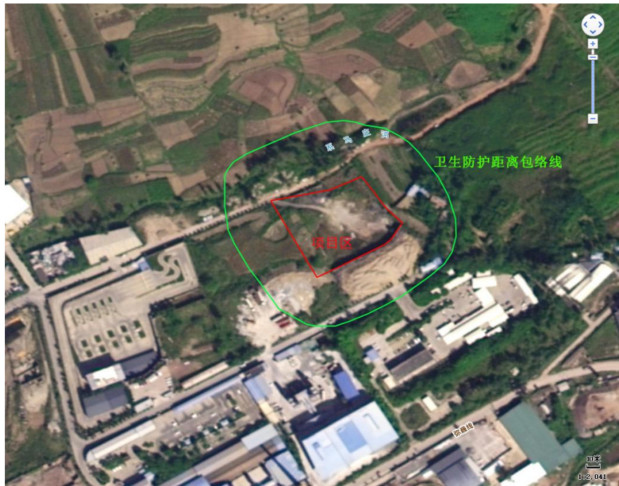
图 6.1-5 项目生产区大气卫生防护距离包络线图
